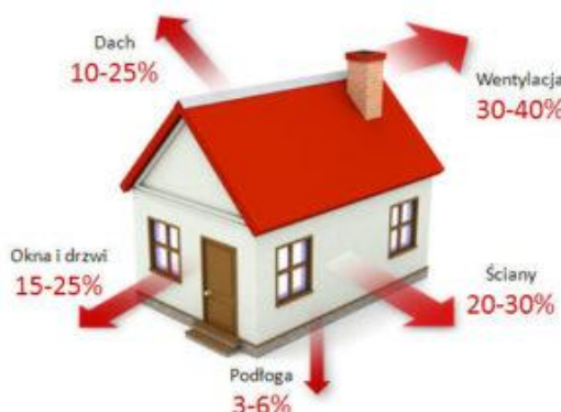
Rysunek 24. Procentowa strata ciepła w budynku 15
